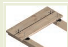
po následném přišroubování odstraníme vymezenou tyčku (kolík) – hotovo!
