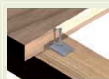
terasovou podlahu pevně přišroubovat GoFixem na nosnou konstrukci
