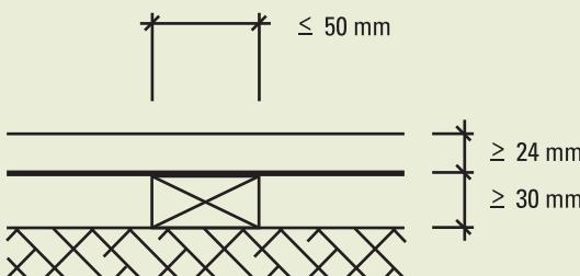
U větších šířek by se měl dodržet odstup min. 7 mm mezi obložením a spodní konstrukcí pomocí prokladů (např. položený ocelový drát, viz obr. 2; dalšími možnostmi jsou hliníkové profily, podložky z umělé hmoty, distanční montážní latě, atd.).
